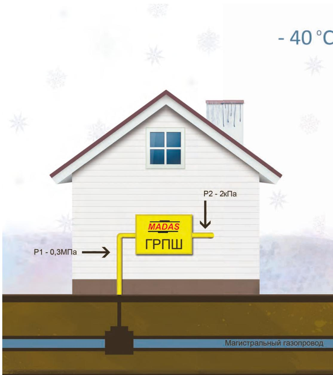
Работа регулятора при температуре -40°C
