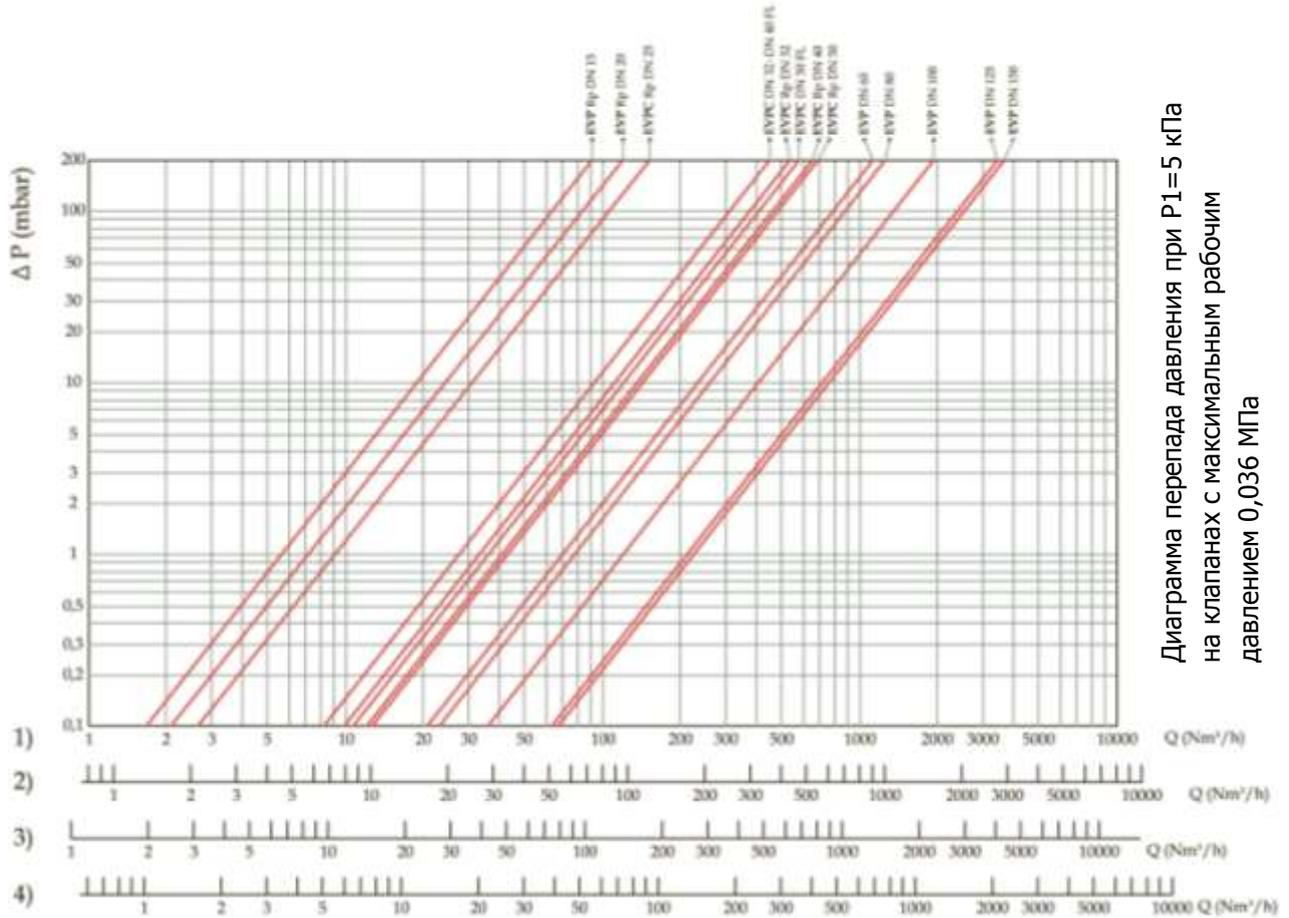
Диаграмма перепада давления при P1=5 кПа на клапанах с максимальным рабочим давлением 0,036 МПа
