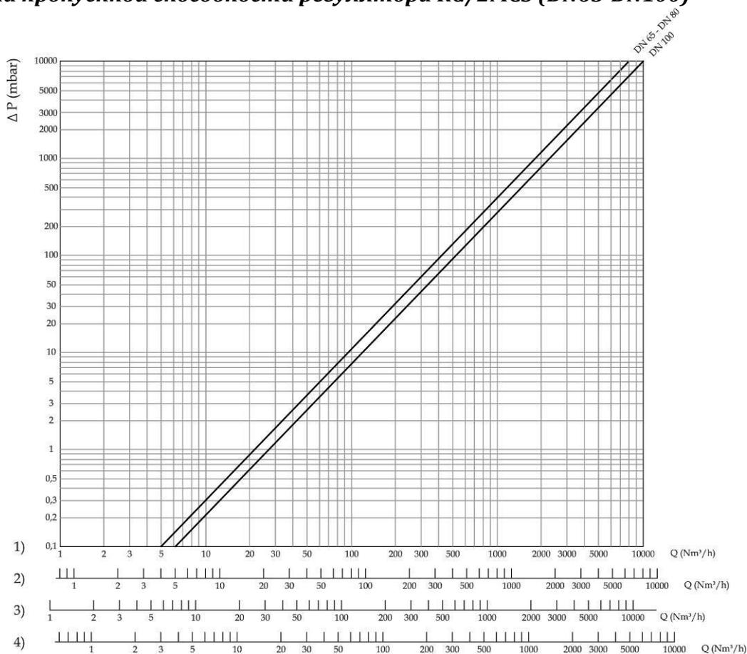
1) метан; 2) воздух; 3) бытовой газ; 4) сжиженный нефтяной газ
